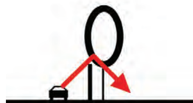
reflectie van geluid over het scherm heen
